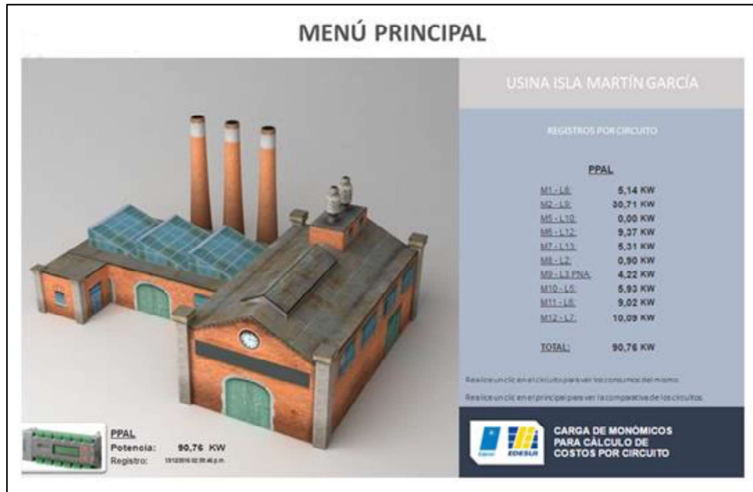
Figura Nº 2 – Pantalla de visualización de la potencia de cada línea en tiempo real
